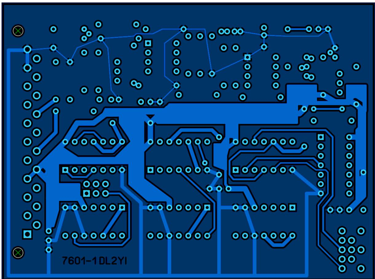
Bild 42a: Druckvorlage Bestückungsseite (BS) 7601 Rev 1 (75x100 mm, vergrößert)
