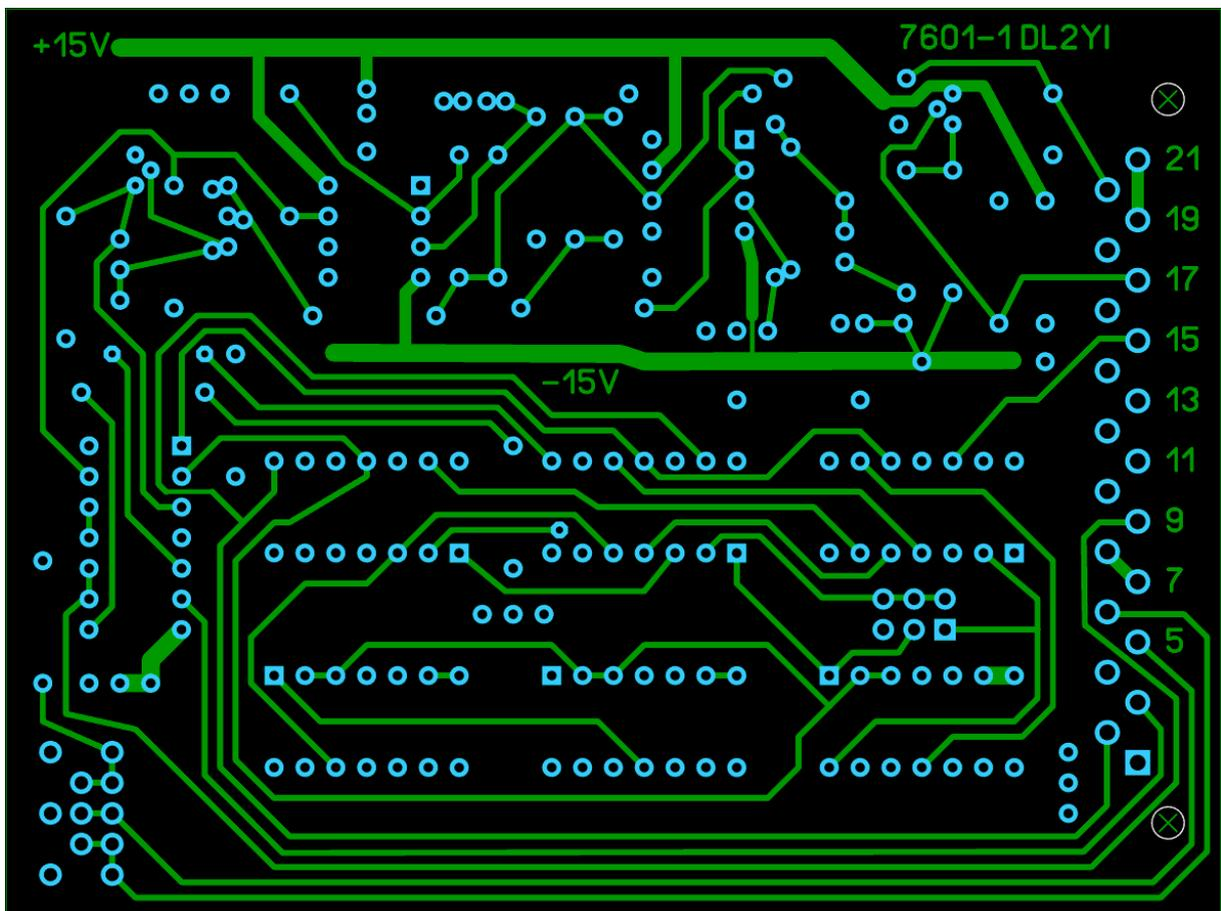
Bild 42a: Druckvorlage Lötseite (ABS) 7601 Rev 1 (75x100 mm, vergrößert)
