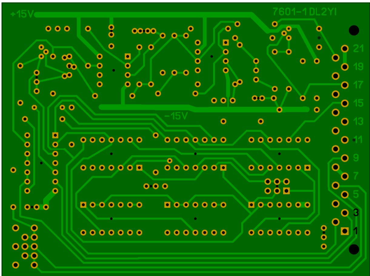
Bild 42c: Leiterplatte Lötseite (ABS) 7601 Rev 1 (75x100 mm, vergrößert)
