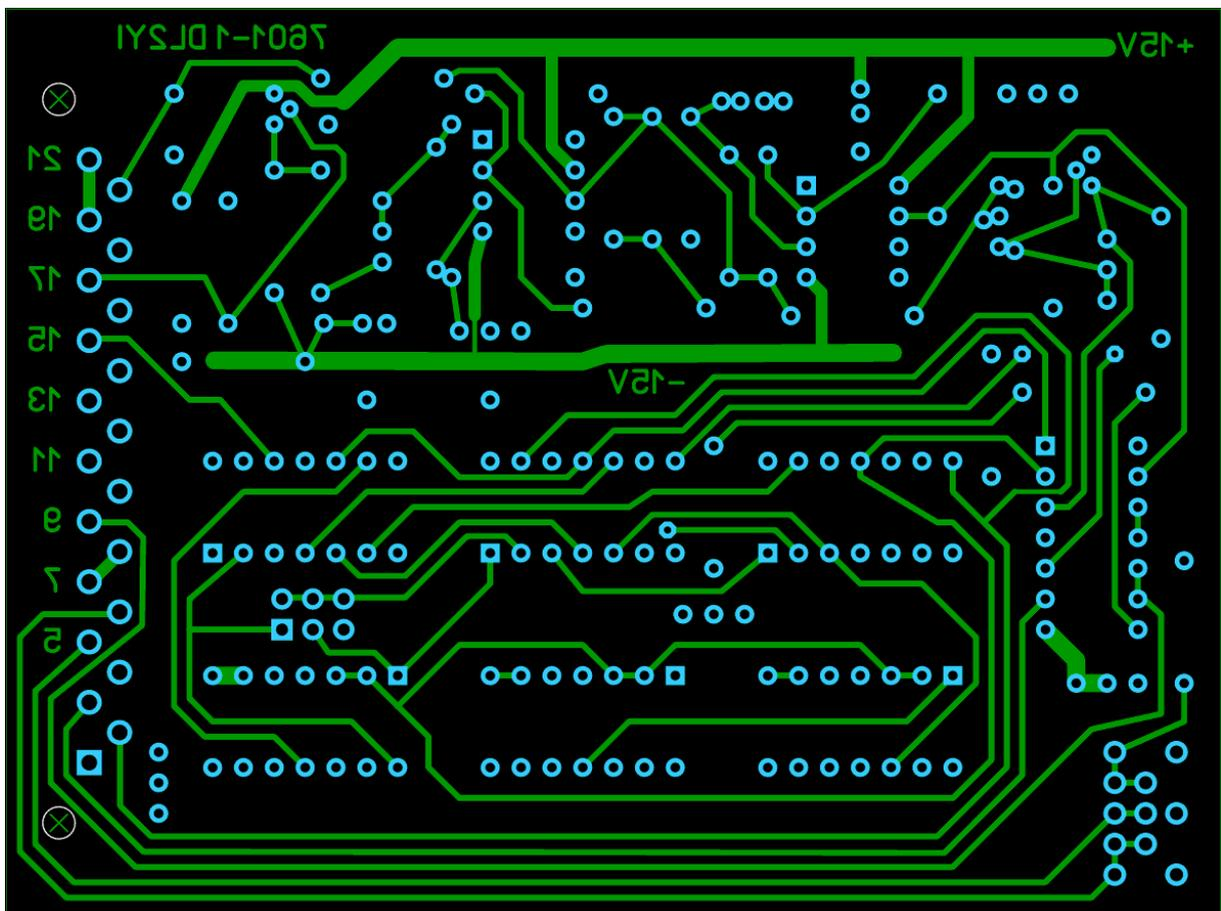
Bild 42e: Leiterplatte Lötseite (ABS) gespiegelt (Durchsicht) 7601 Rev 1 (75x100 mm, vergrößert)
