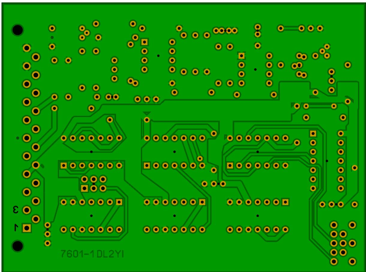
Bild 42d: Leiterplatte Bestückungsseite (BS) 7601 Rev 1 (75x100 mm, vergrößert)
